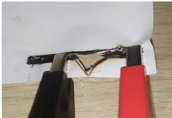
Obr. 9. Čára pod termokamerou. Obr. 10. Čára zapálila papír, poté se obvod přerušil.
