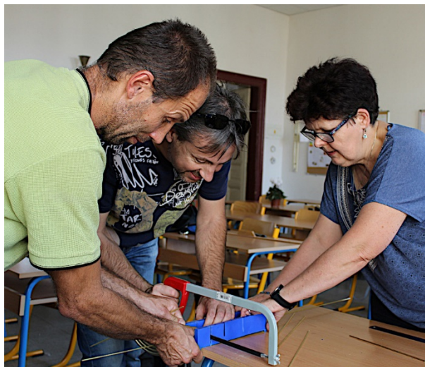
Obr. 4. Řezání mosazné trubky.
