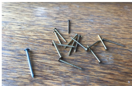
Obr. 8. Hřebíčky potřebné k nepájenému spoji.
