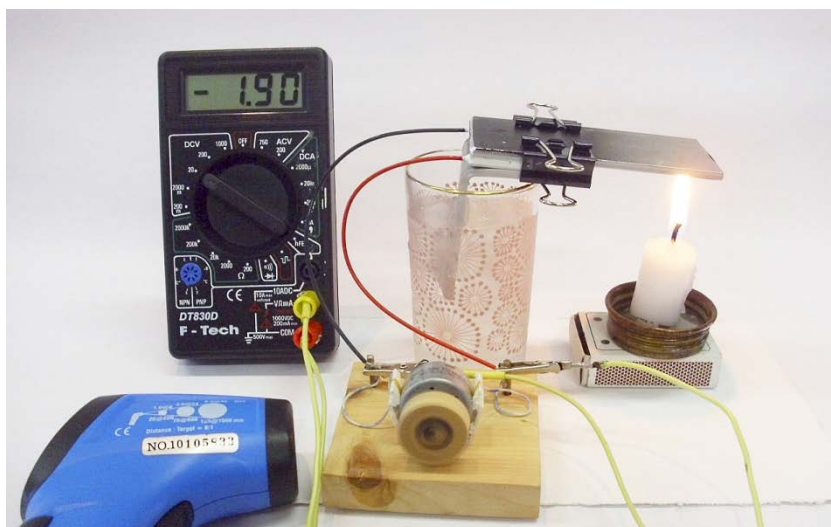
Obr. 7. Sestava Peltierova článku s hliníkovým přívodem a odvodem tepla.
