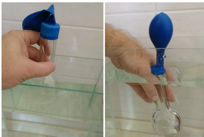
Obr. 9. Vlevo balónek před ponořením láhve do vody, vpravo nafouknutý balónek po ponoření láhve do vody.
