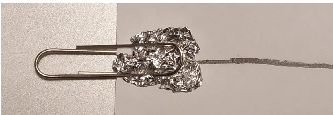
Obr. 1. Kontakt mezi čarou a vodičem pomocí alobalu a sponky.
