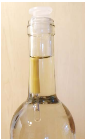
Obr. 7. Oční kapátko připravené jako potápěč ve skleněné láhvi s plastovou zátkou.
