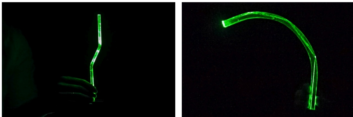
Obr. 40. Vlevo: optické vlákno ze skleněné chemické tyčinky. Vpravo: optické vlákno z ohnutého plastového hranolu.
