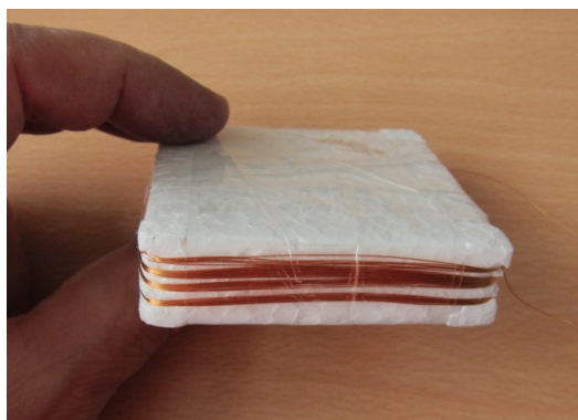
Obr. 2. Detail cívky navinuté na polystyrenovou destičku.
