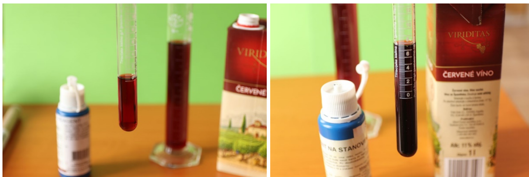
Obr. 5. Vlevo červené víno ve zkumavce, vpravo výsledný roztok připravený k odečtení hodnoty volné síry na stupnici zkumavky.
