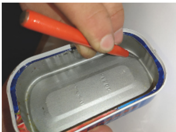
Obr. 10. Prorážení díry pro trubičku.
