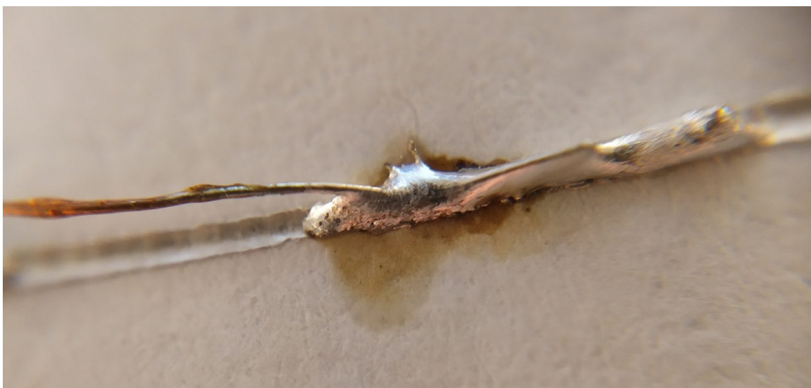
Obr. 13. Na čáru nakreslenou propiskou od firmy Circut Scribe je možné pájet.
