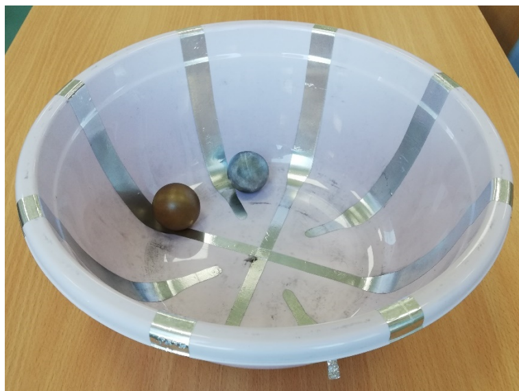
Obr. 14. Varianta „velká mísa z tvrdého plastu“ s pingpongovým míčkem a polystyrenovou kuličkou, vpředu vykukuje druhý kontakt.
