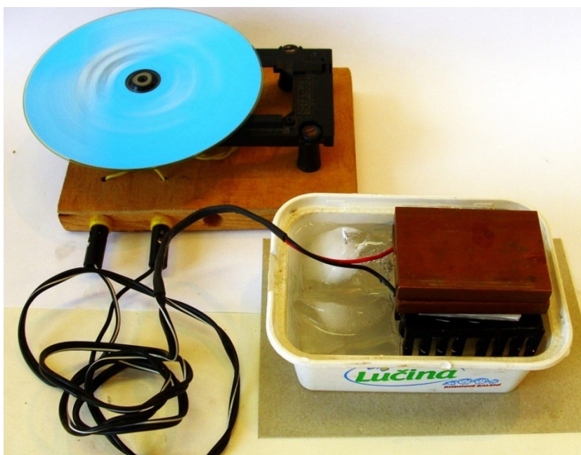
Obr. 9. Peltierův článek leží na chladiči z počítače. Chladič je ponořen do ledové vody, která ho udržuje na nízké teplotě. Navrchu leží dva měděné hranoly, které byly původně ohřátý v horké vodě na teplotu cca 50 °C. V tomto uspořádání dává Peltierův článek napětí cca 1,3 V a proud okolo 150 mA.
