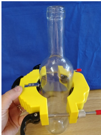
Obr. 6. Přípravek na řezání skleněných láhví, který je k sehnání na AliExpress.
