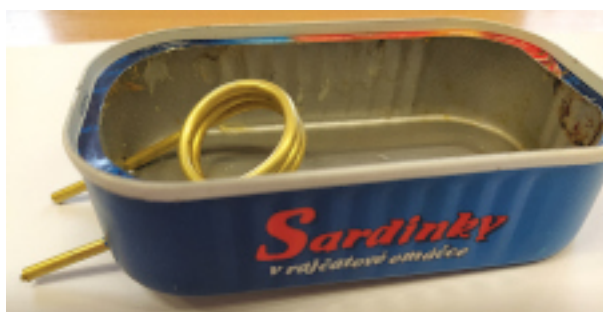
Obr. 11. Zasazení trubičky do plechovky.
