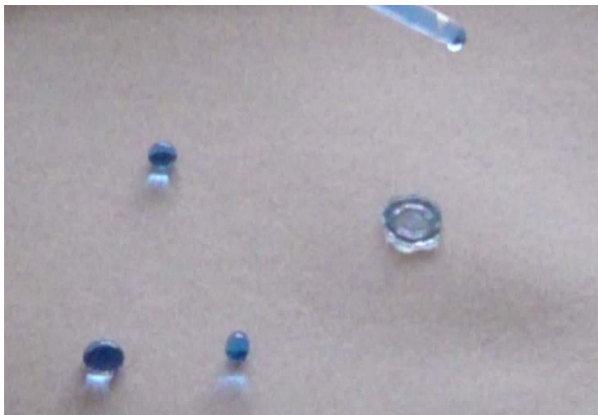
Obr. 5. Dopad vodních kapek na papírový tácek s hydrofobním povrchem (výřez z videa).
