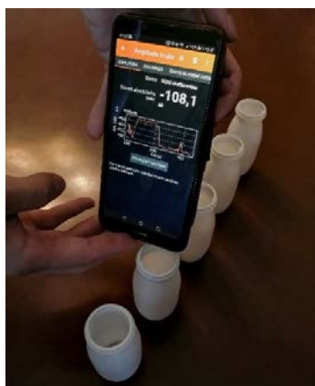
Obr. 3. Vlevo – akustický model STM s pěti kelímky (atomy), telefon s viditelnou obrazovkou je přijímač, druhý telefon (skrytý za prvním) je vysílač, mikrofon přijímače a
