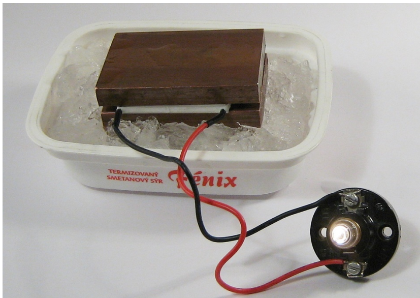
Obr. 8. Nejjednodušší sestava pro rozsvícení žárovky. Jeden měděný hranol leží na ledové drti, na něm leží článek a navrch je položen druhý měděný hranol ohřátý na cca 50 °C. Téměř naplno rozsvítí malou žárovku 1,2 V/0,22 A.
