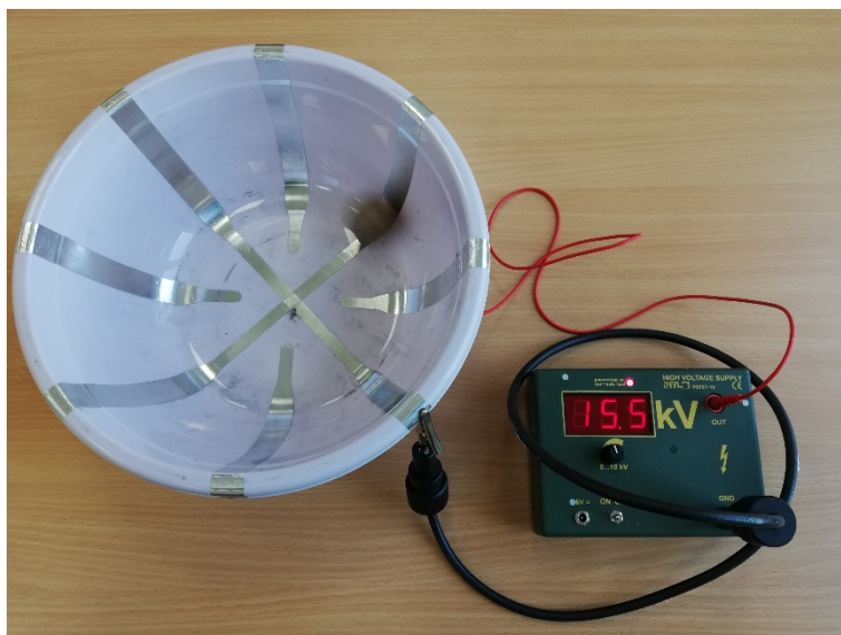
Obr. 15. Připojení varianty „velká mísa z tvrdého plastu“ ke školnímu zdroji VN P3127-1V.
