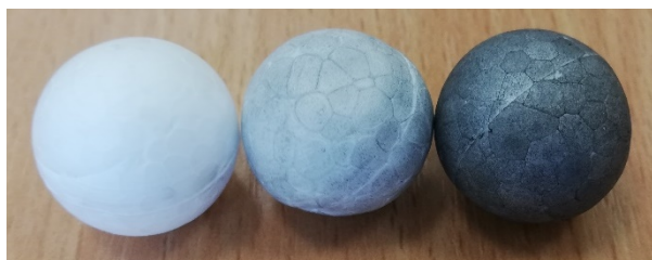
Obr. 9. Polystyrenové kuličky – bílá bez úpravy, světle šedá jen slabě vodivá, tmavě šedá až černá s dobře vodivým povrchem.
