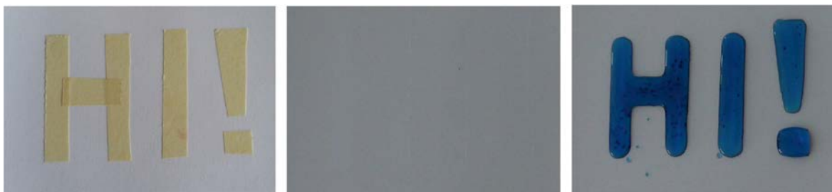
Obr. 7. Nápis „Hi!“ vytvořený malířskou páskou (vlevo), po nastříkání a sundání pásky není vidět (uprostřed) a po nalití vody (vpravo).
