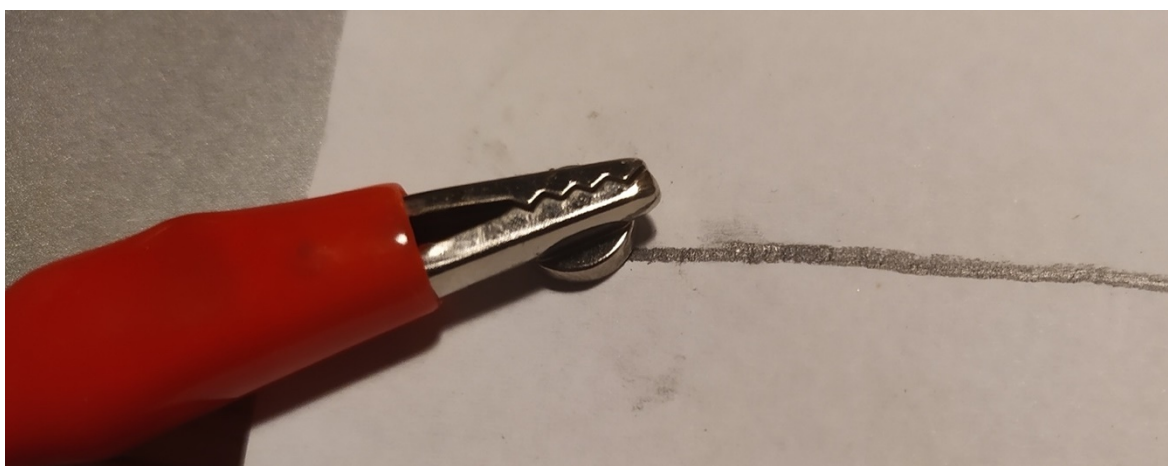
Obr. 3. Kontakt mezi čarou a vodičem pomocí magnetu a krokosvorky.
