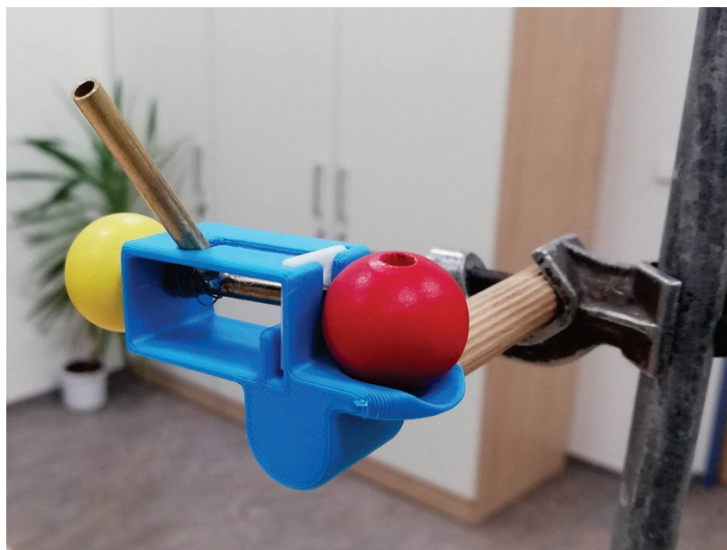
Obr. 2. Verze pomůcky s využitím 3D tisku – pružinka ve stlačeném stavu, žlutá kulička nasazená na vysunutou trubičku, červená kulička leží na plošce, připraveno k „odpalu“
