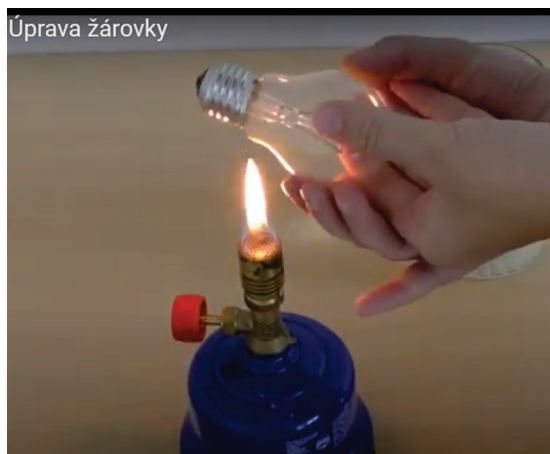
Obr. 2. Odstraňování skla. Převzato z [1]. (Poznáte, čím jsou ruce na fotce?)
