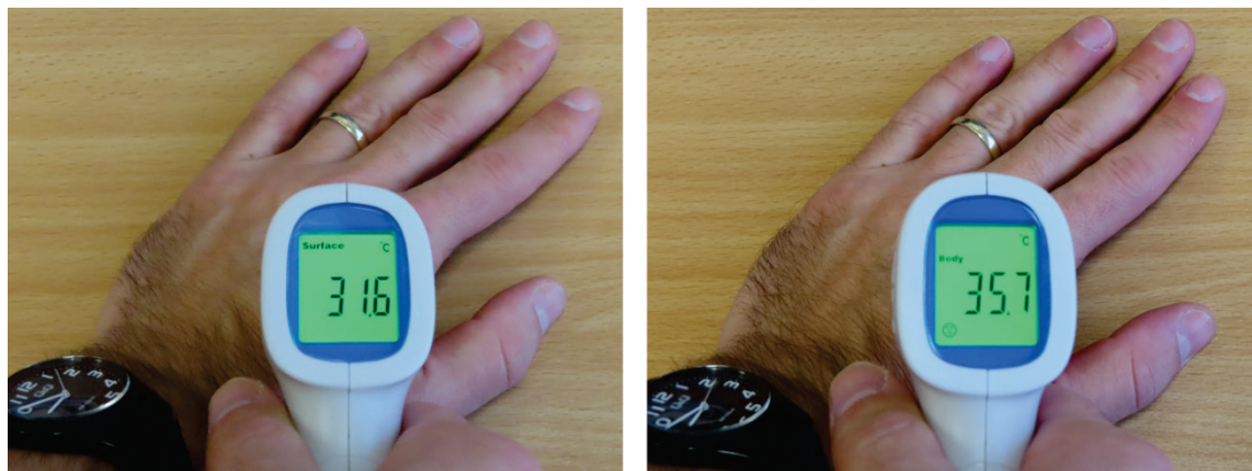
Obr. 2. Měření téhož povrchu – lidské ruky – bezkontaktním teploměrem (několik sekund po sobě, ze stejné vzdálenosti). Vlevo teploměr v režimu surface , vpravo v režimu body .
