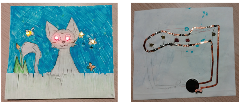
Obr. 5. Obrázek s paralelním zapojením LEDek.
