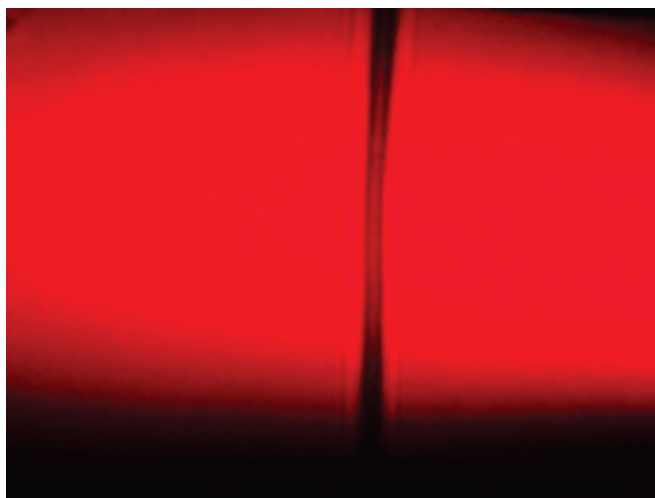
Obr. 6. Demonštrácia ohybu svetla na vlase, využili sme laserovú diódu bez šošovky.
