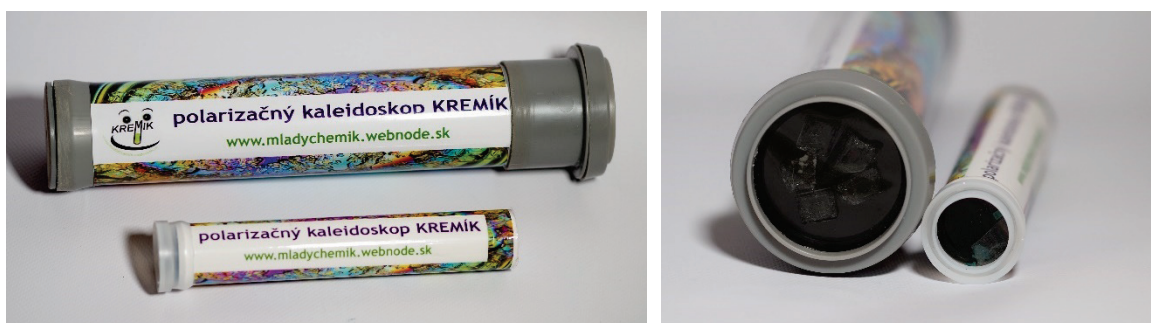
Obr. 20. Kryštálikový polarizačný kaleidoskop
