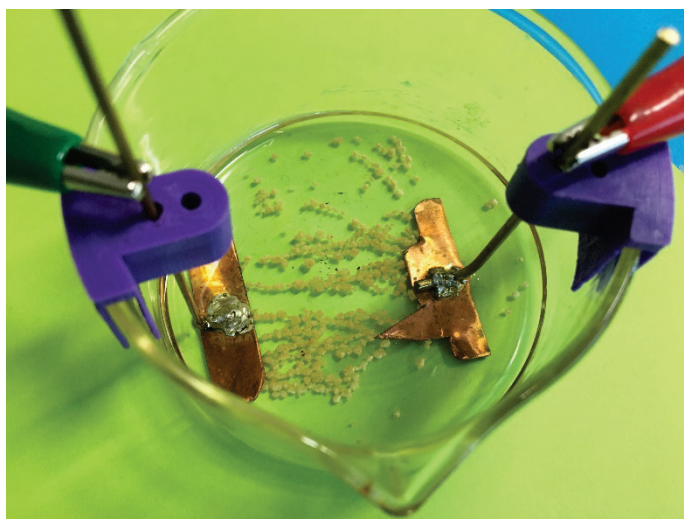
Obr. 5. Elektrické pole v okolí tělesa s hrotem (věž kostela).
