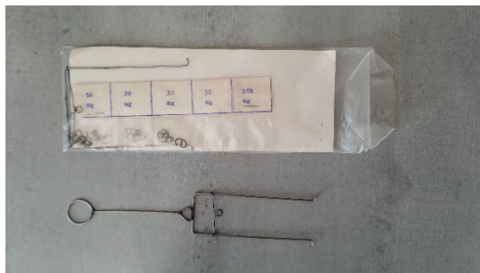
Obr. 16. Originální rámeček pro měření povrchového napětí.
