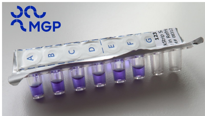
Obr. 7. Zkumavky QuickStrip™ obsahující vzorky DNA jsou překryty hliníkovou fólií. Jednotlivé sady osmi zkumavek pro samostatné experimenty lze jednoduše oddělit rozstřížením fólie nůžkami.
