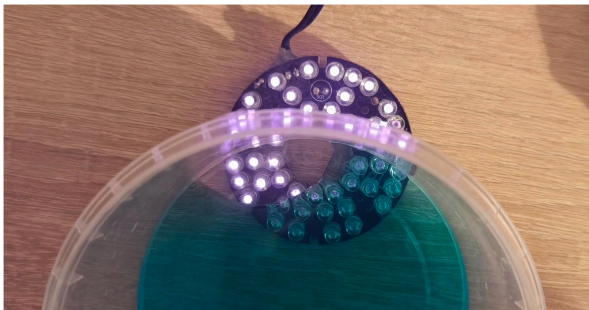
Obr. 13. IR záření je blokováno už několikamilimetrovou vrstvou roztoku modré skalice.
