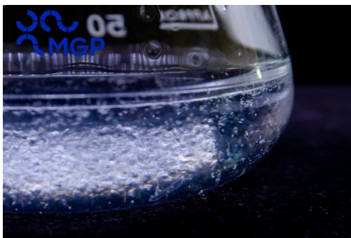
Obr. 4. Nedostatečně rozvařená agaróza. Správně připravená agaróza nesmí obsahovat ani stopy opaleskujících nerozvařených zrn.
