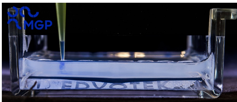
Obr. 8. Ukázka nanášení vzorku na gel. Pipetovací špičku musíme ponořit do pufru těsně nad jamku a vzorek pomalu vypustit do jamky. Vzhledem k vyšší hustotě vzorkového pufru klesá vzorek sám ke dnu jamky.
