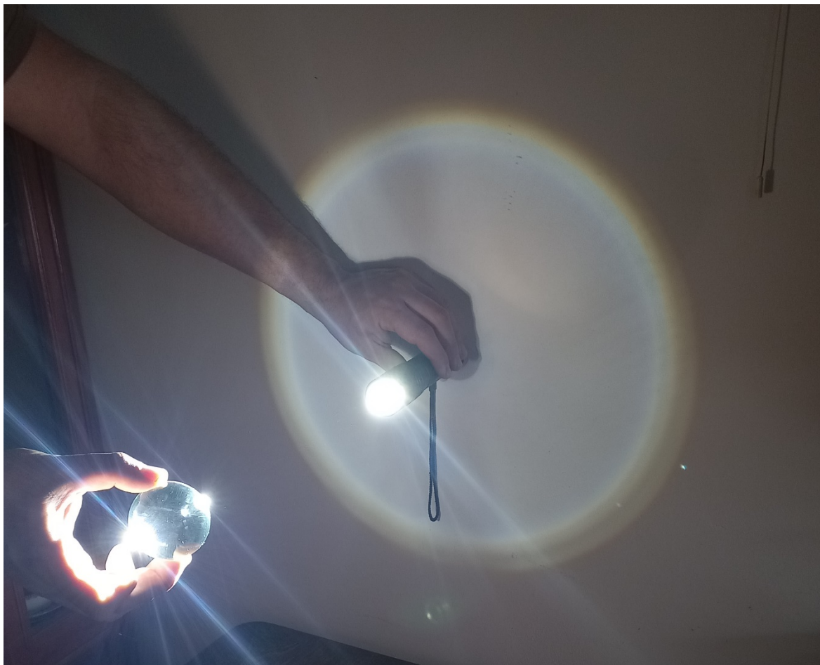
Obr. 5. Simulace průchodu světla kapkou – skleněnou koulí o poloměru 5 cm. Vystupující paprsky jsou omezeny Descartesovým úhlem, na okraji kužele je patrná vyšší intenzita světla i rozklad světla do barev. Uprostřed kužele se rozložené světlo skládá zpět do bílého světla.
