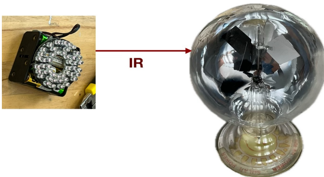
Obr. 3. Crooksův mlýnek [10] a IR reflektor pro noční vidění.
