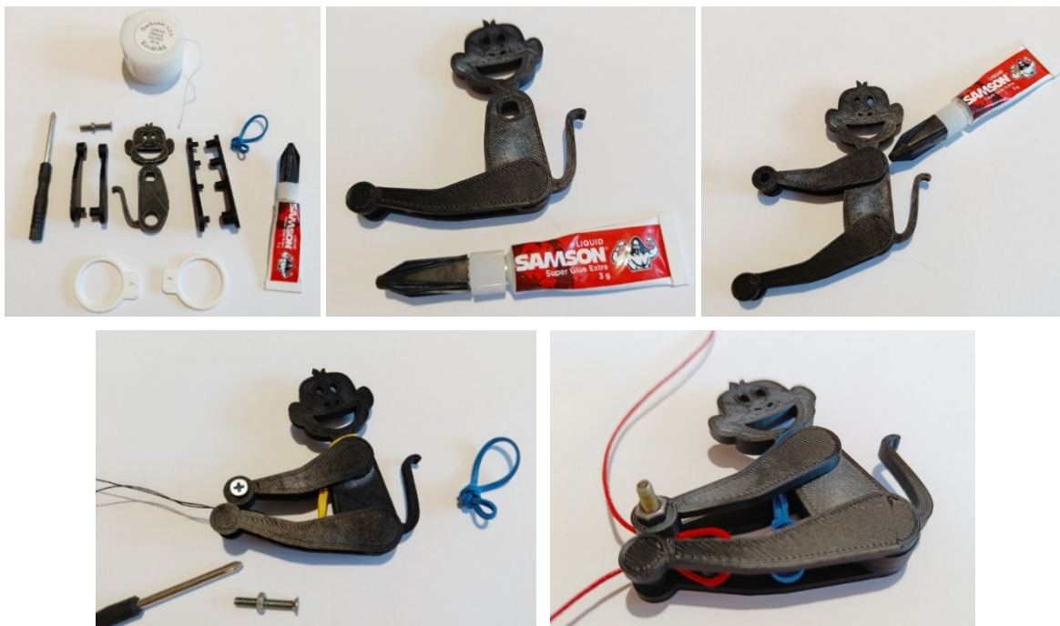
Obr. 8. Postup při výrobě opičky šplhající po jednom laně.
