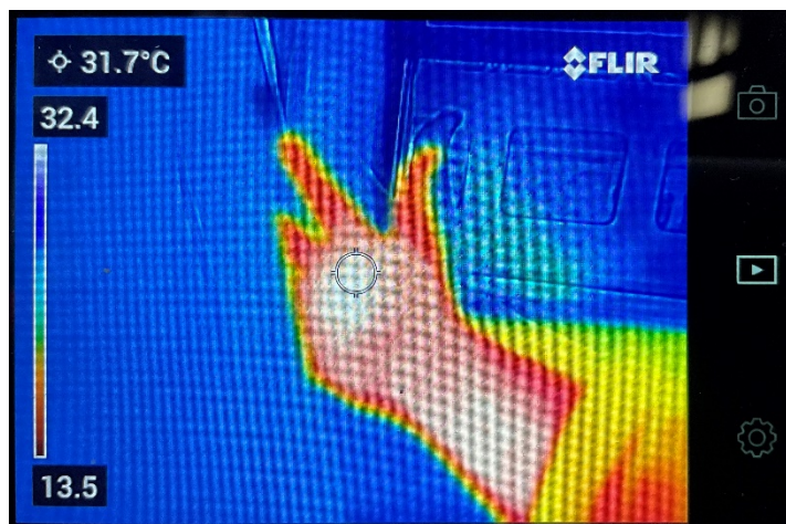
Obr. 2. Ruka jako zdroj dlouhovlnného IR záření. Vlevo sklo, přes které IR záření neprojde.
